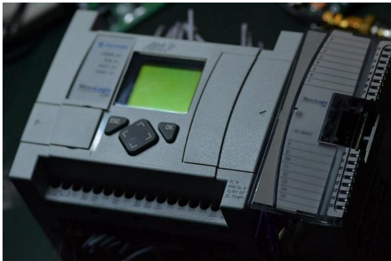
**FIGURA 23:** Controlador lógico programable MicroLogix 1100 (PLC).
