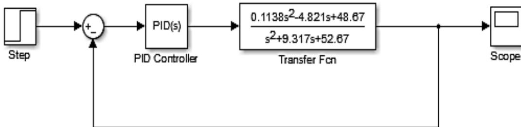
**FIGURA 94:** Diagrama de bloques en Simulink.
