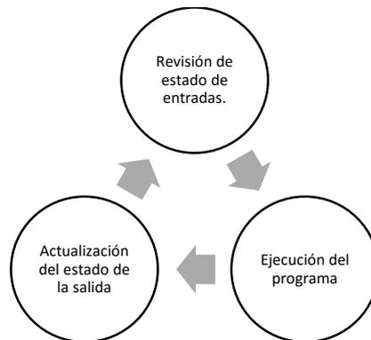
**FIGURA 24:** Pasos principales para la operación de un PLC.
