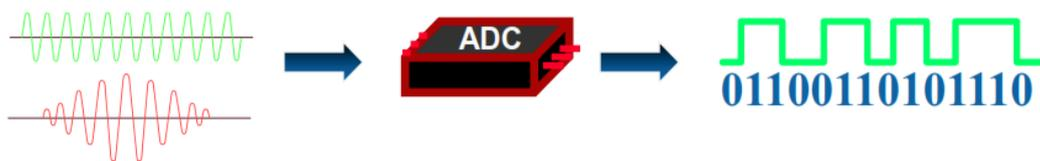
**FIGURA N°. 18** Conversor ADC
