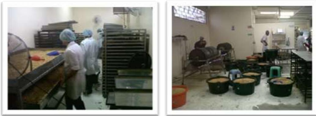
4. Constan de un sistema poco ortodoxo de enfriamiento del producto debido a que pasa mucho tiempo expuesto a las condiciones medio ambientales del área incrementando las posibilidades de producirse una contaminación de tipo físico en gran proporción.
