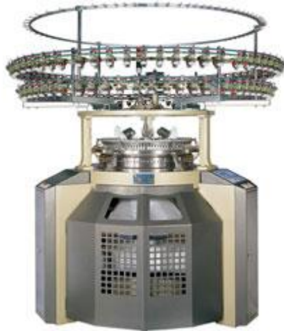
Figura N° 7: Tricotosa circular (género de punto por trama).
