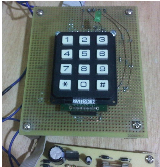
Figura 3.22 Teclado para la activación/desactivación de la alarma.
