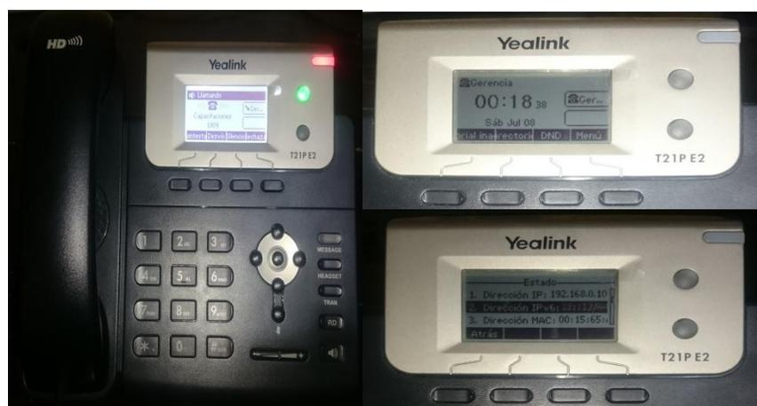
**Figura 64 Revisión de dirección IPv6 en el teléfono IP**
