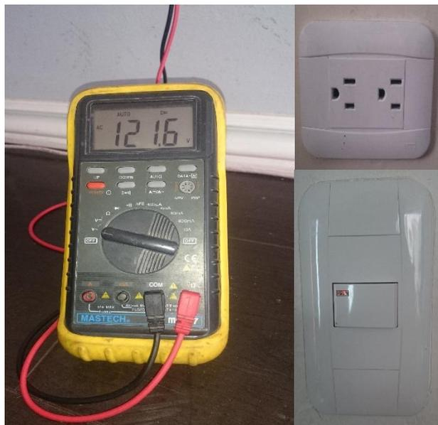
**Figura 26** *Medición de la tensión en los toma corrientes e interruptores*
