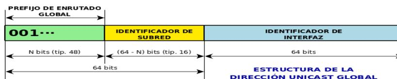
**Figura 15 Formato dirección unicast global**
