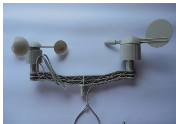
FIGURA 2.3: Ensamblaje sensor velocidad del viento(b)
