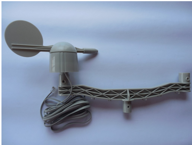
FIGURA 2.1: Ensamblaje sensor dirección del viento
