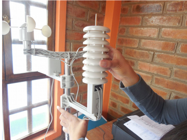
FIGURA 2.11: Deslizar el protector contra la lluvia del termohigrómetro
