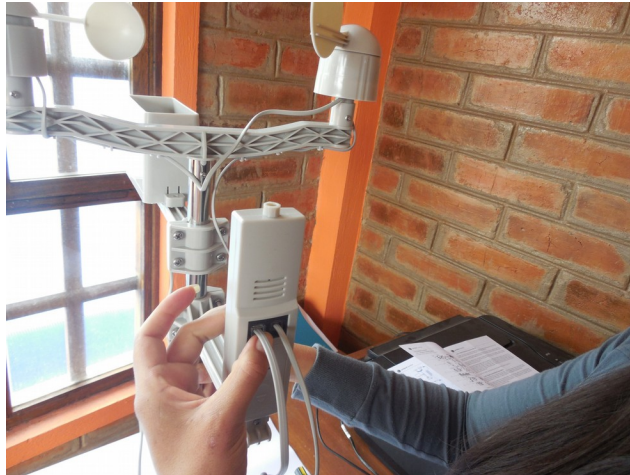
FIGURA 2.9: Conectar cables al termohigrómetro
