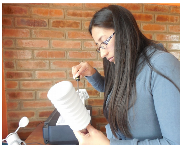
FIGURA 2.8: Ensamblaje del termohigrómetro (b)
