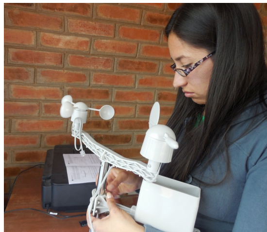
FIGURA 2.6: Ensamblaje del indicador de lluvia (b)
