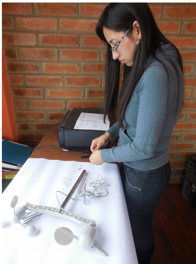
FIGURA 2.4: Ensamblaje del conjunto anemómetro al polo
