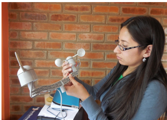
FIGURA 2.2: Ensamblaje sensor velocidad del viento(a)
