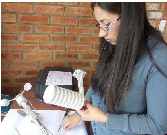
FIGURA 2.7: Ensamblaje del termohigrómetro (a)
