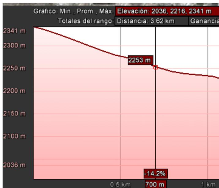
Figura 24. Perfil de elevación para la distancia de 3.5 km.
