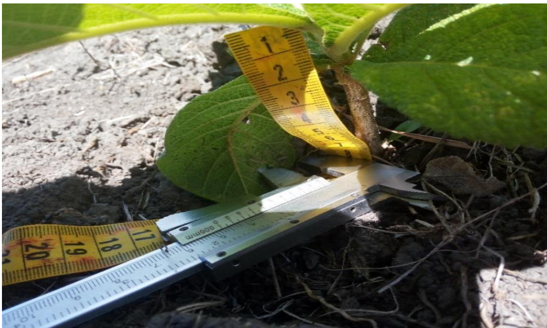
Ilustración 4: Medición con calibrador pie de rey y cinta métrica. Fuente: Janneth Patricia Obando Alvarado
