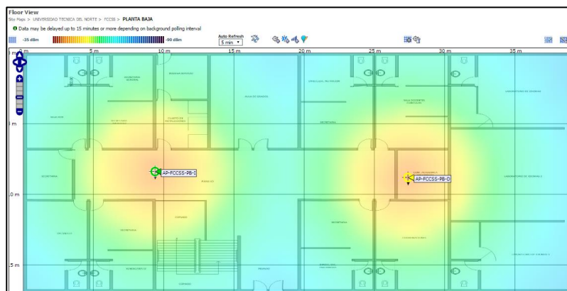
Figura 134. Cobertura Planta Baja Edificio FCCSS
