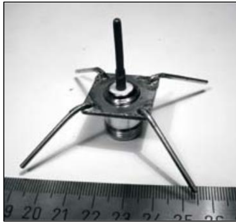
Figura 17. Antena de 1/4 de longitud con plano de tierra
