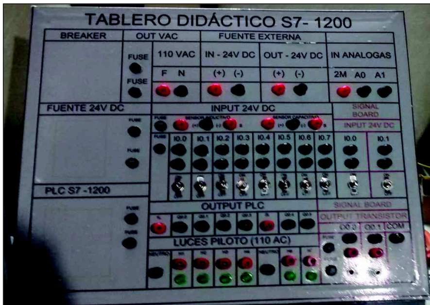
Figura 101: Colocación de jack tipo banana hembra para el tablero didáctico del PLC S7 - 1200
