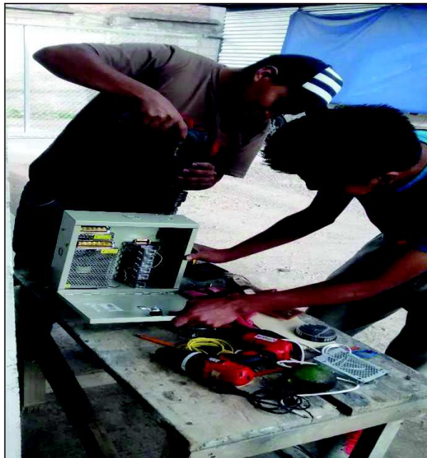
Figura 107: Perforación para los conectores jack tipo banana
