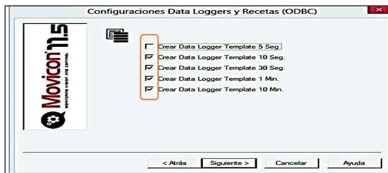
Figura 23: Configuración data loggers en Movicon 11.4
