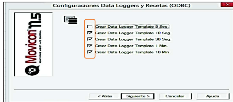
Figura 87: Configuración data loggers en Movicon 11.4
