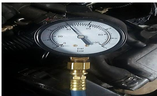
Figura 32. Medición de la presión de combustible en la línea de alimentación.
