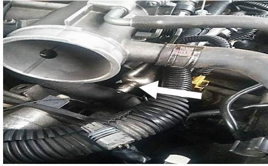
Figura 30. Cañería desconectada del riel de inyectores.
