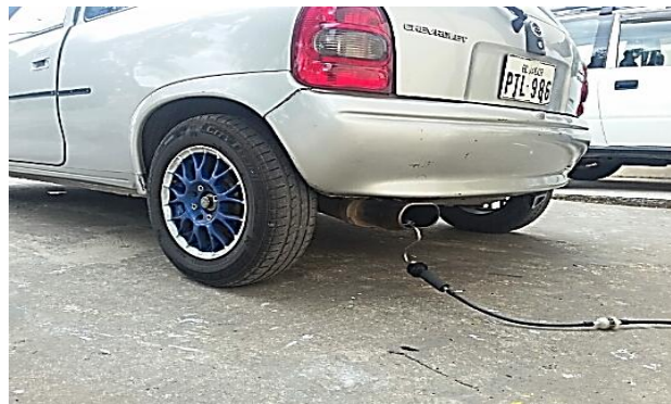
Figura 48. Instalación de la sonda de prueba.
