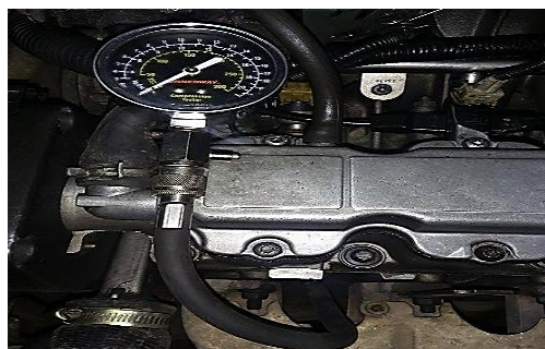
Figura 35. Instalación del manómetro para medir compresión.
