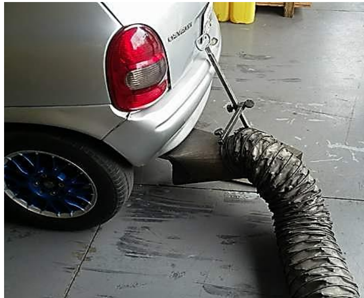
Figura 63. Acople de sistema de absorción de gases.
