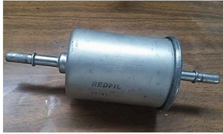
Figura 26. Filtro de combustible.
