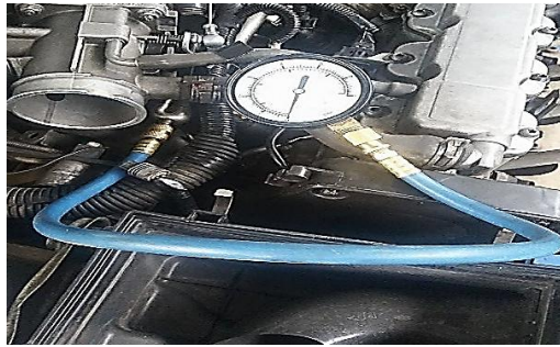
Figura 31. Manómetro de presión conectado.
