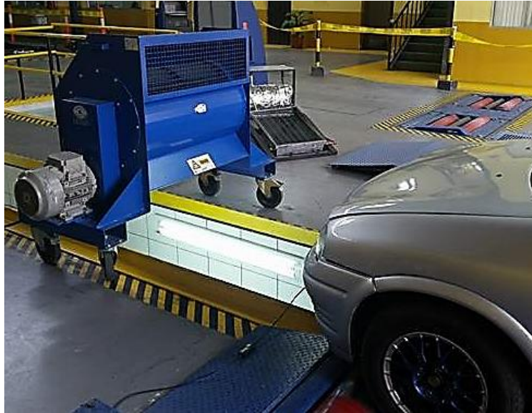
Figura 62. Colocación del ventilador refrigerante.
