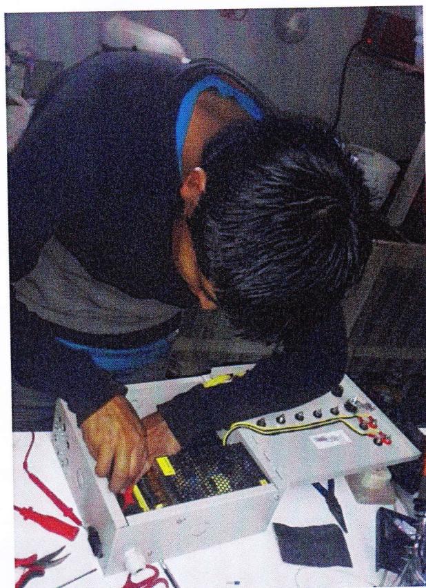
Figura 143: Instalación de la alimentación a 110 VAC de la caja de control
