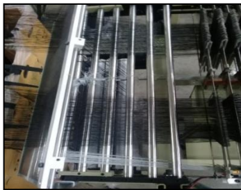
Figura 23: Barras de cruce
