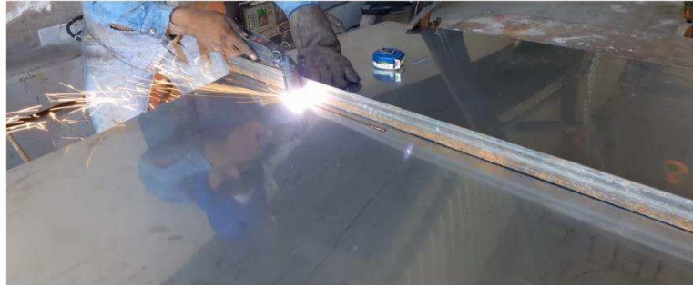
Figura 3.18. Corte de lámina de acero inoxidable.
