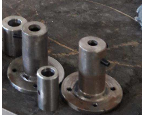
Figura 3.22. Construcción de las bridas.
