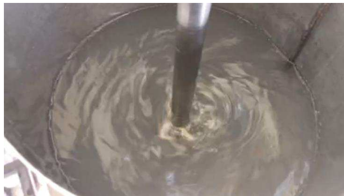
Figura 4.4. Mezcla tanque de metóxido.
