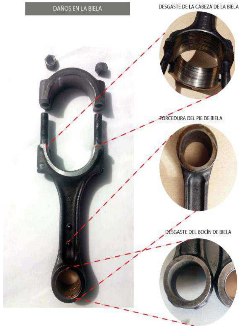
Figura 3.3. Zonas donde se produce el desgaste en la biela
