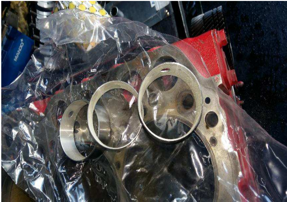
Figura 3.15. Colocación de bujes del árbol de levas en el motor Hino 205
