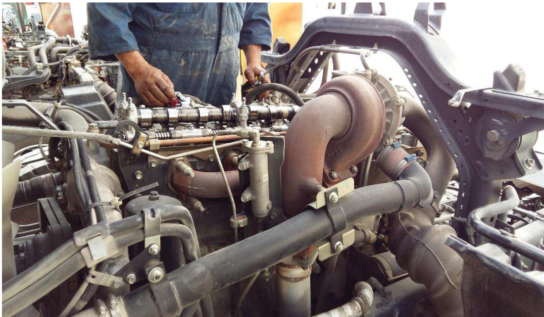
Figura 3.21. Montaje del tren de balancines e inyectores a un motor Hino 205 cruce de válvulas correspondientes al primer cilindro, de este modo las válvulas a
