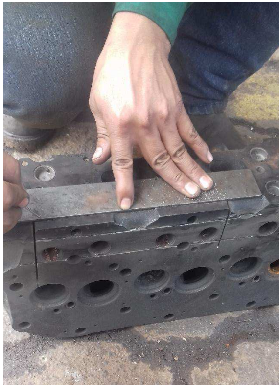
A9.1 Extracción de muestras para el ensayo de tracción
