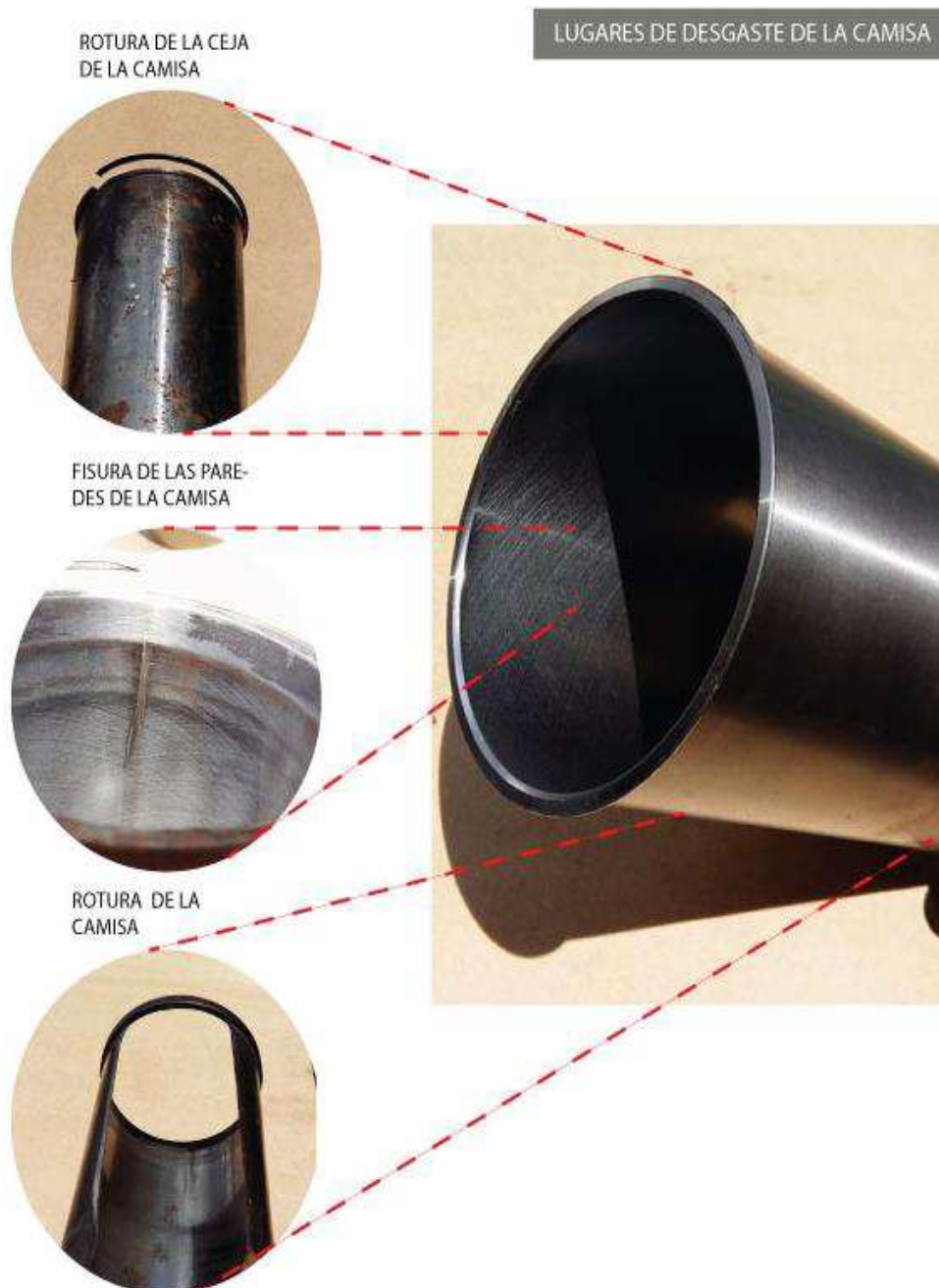
Figura 3.7. Zonas de desgaste de los segmentos y camisas
