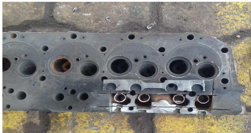
Figura 3.24. Diseño y extracción de la probeta para el ensayo de tracción
