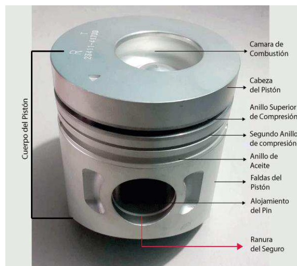
Figura 2.7. Pistón de un motor diésel con sus respectivas partes
