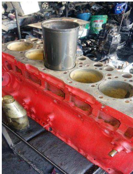
Figura 3.17. Montaje de las camisas del bloque motor de un Hino 205
