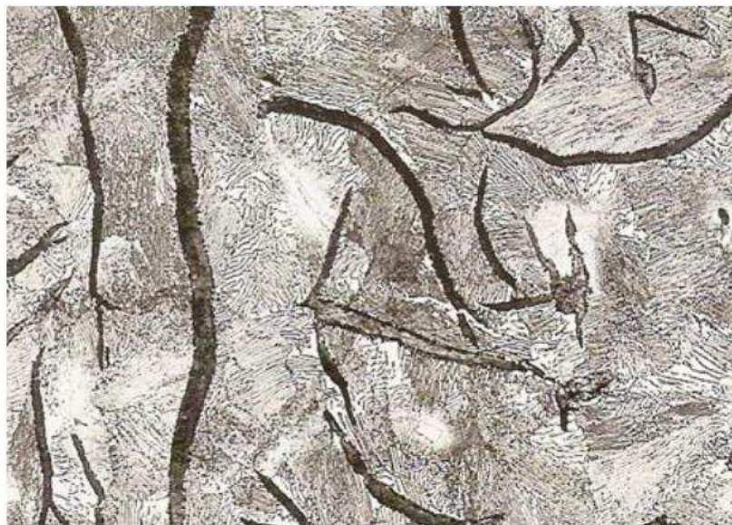
Figura 2.20. Micro estructura de una matriz perlítica de un hierro fundido gris Fuente: (Gil, 2002)
