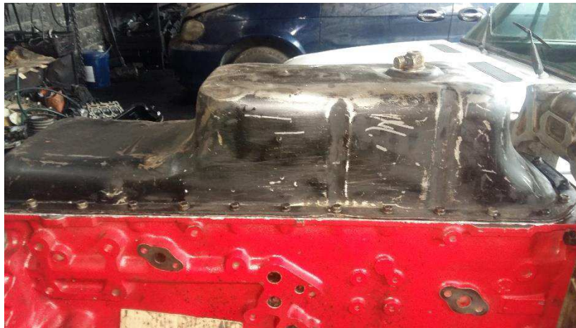
Figura 3.19. Montaje del cárter de un motor Hino 205
