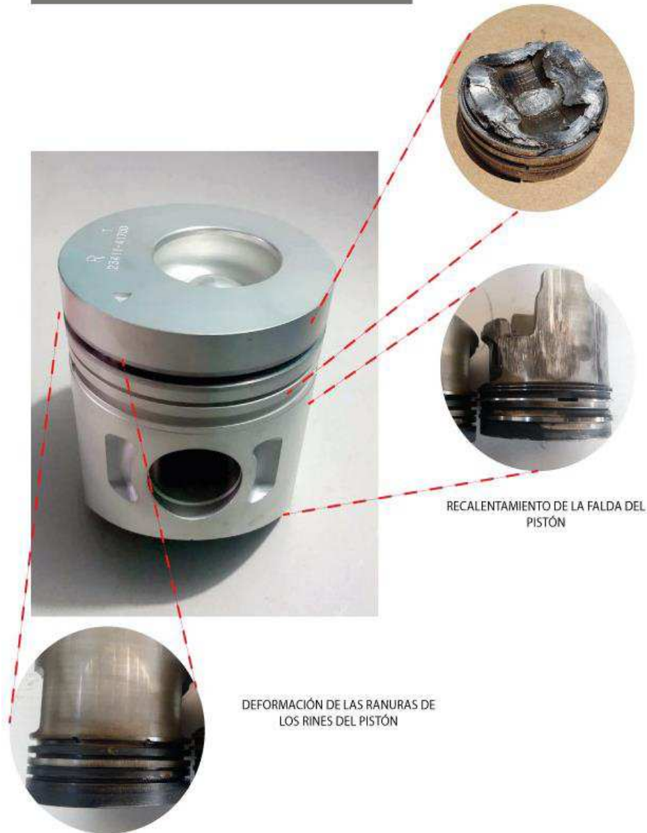
Figura 3.5. Zonas de desgaste del pistón
