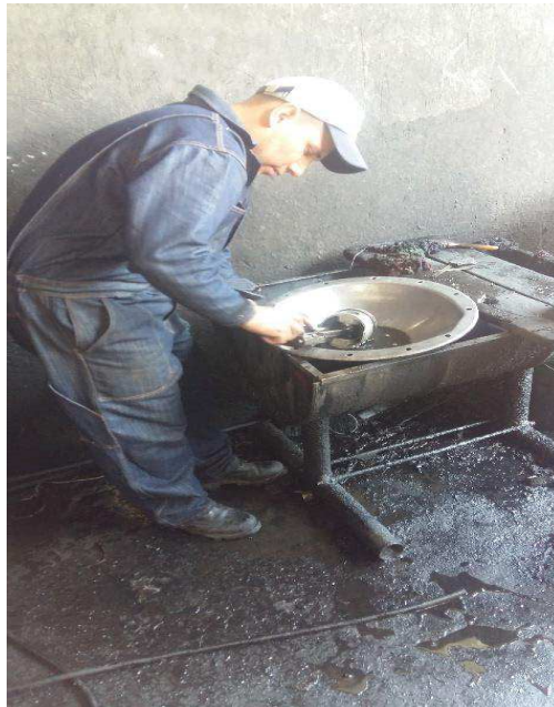
Figura 3.12. Lavado del bloque motor y pulida cigüeñal de un motor Hino 205
