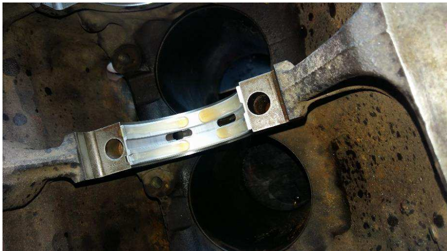
Figura 3.13. Comprobación de rayaduras en los cojinetes de bancada
