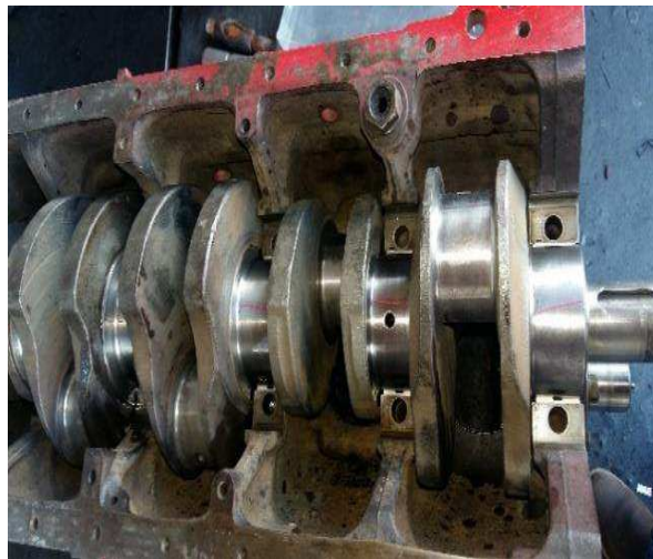
Figura 3.14. Comprobación del ajuste de la película de aceite en los muñones de bancada
