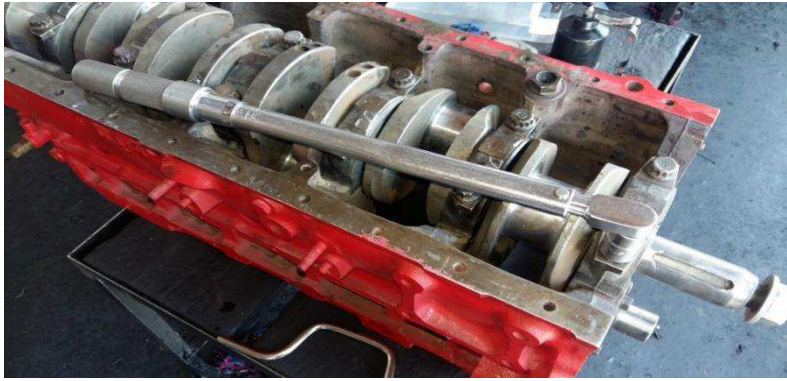
Figura 3.16. Montaje del cigüeñal en bloque motor de un motor Hino 205
