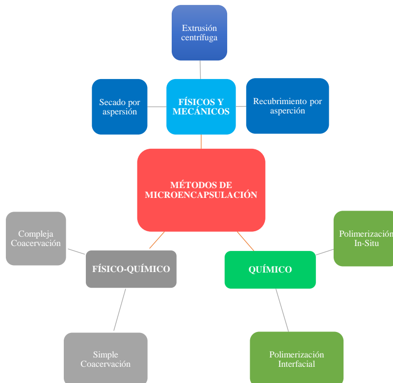
Ilustración 1. Método de formación de micro-cápsulas
