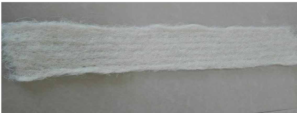
Figura 32. No tejido punzonado de fibras de piña aplicado tres pasadas.
