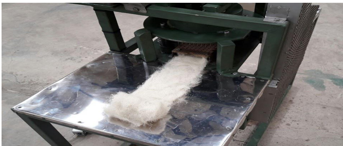
Figura 31. Velo de fibras de piña dándose paso por la punzonadora.
