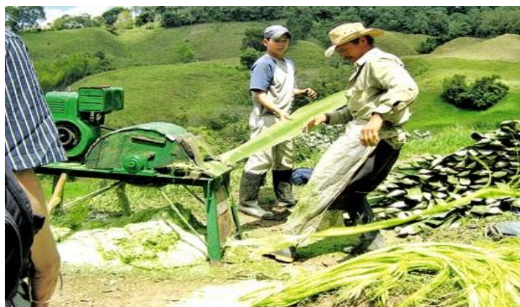
Figura 8. Desfibrado del Fique mediante máquina.
