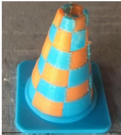
Figura 3.6. Impresión de un cono de dos colores
