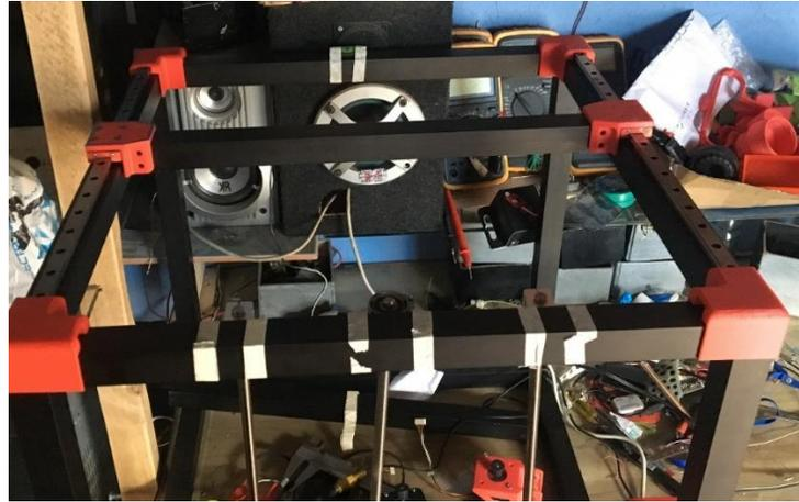
Figura 2.25. Montaje de carros de desplazamiento
