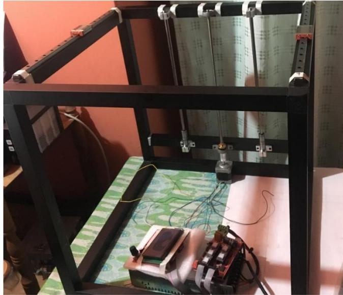
Figura 2.24. Montaje de varillas de sujeción.
