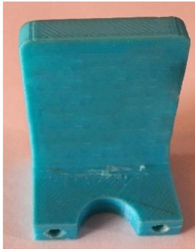
Figura 3.11. Mejora para evitar que el extrusor pierda su posición vertical.
