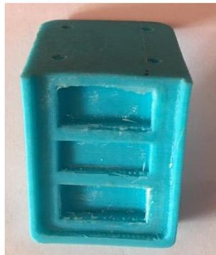
Figura 3.8. Impresión del soporte del extrusor.
