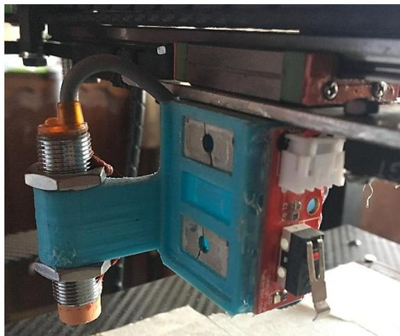
Figura 3.10. Switch de inicio de carrera en el eje X.
