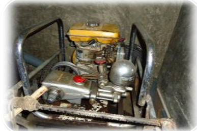
Bomba a motor
