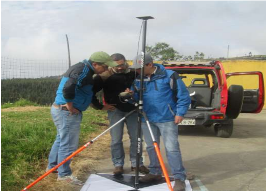
Fotografía 3. Geo referenciación de puntos de control con GPS de doble frecuencia, Mgs. José Guzmán UTN, Mgs. Vinicio Fuentes GPI, Ing. Diego Ruales maestrante.
