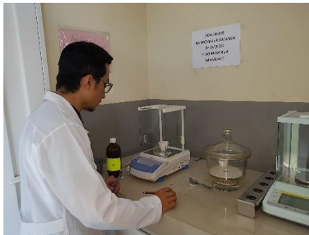
Preparación de la muestra para determinación de cenizas
