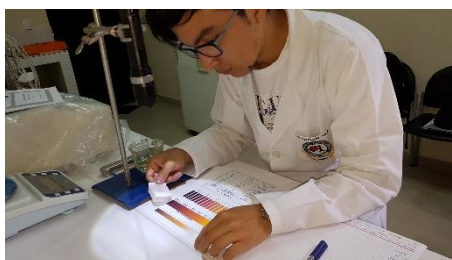
Determinación de la escala de color por el método Pfund
