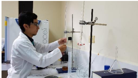
Preparación de buretas de titulación para determinación de acidez
