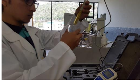
Determinación de la conductividad eléctrica de la miel de abeja
