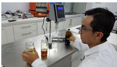
Preparación de la muestra para determinación de viscosidad
