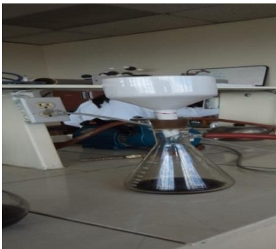
Foto: Filtrado con bomba de vaciado.
