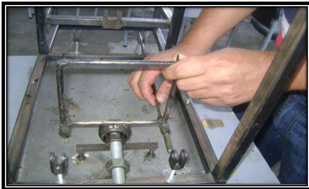
FIGURA 73: Colocación barras estabilizadoras
