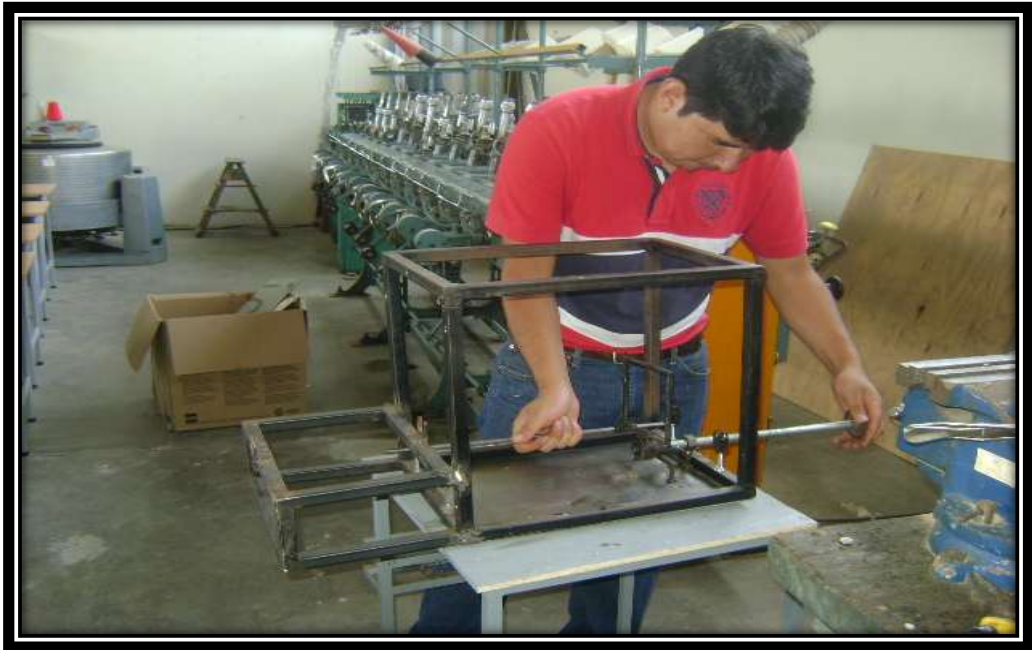
FIGURA 70: Colocación de tornillo sin fin
