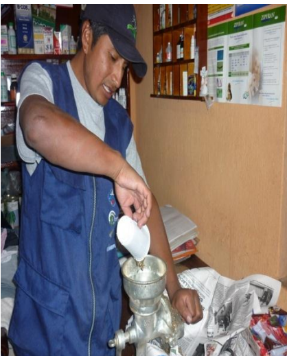
Fotografías 5, 6.- Triturado y secado del desperdicio de pescado cocido
