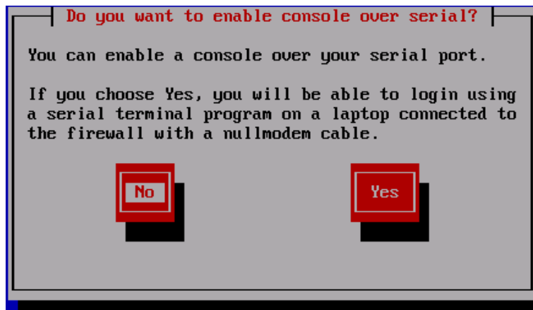
Figura 131. Activación de comunicación por puerto Serial Fuente: realizado por el autor
