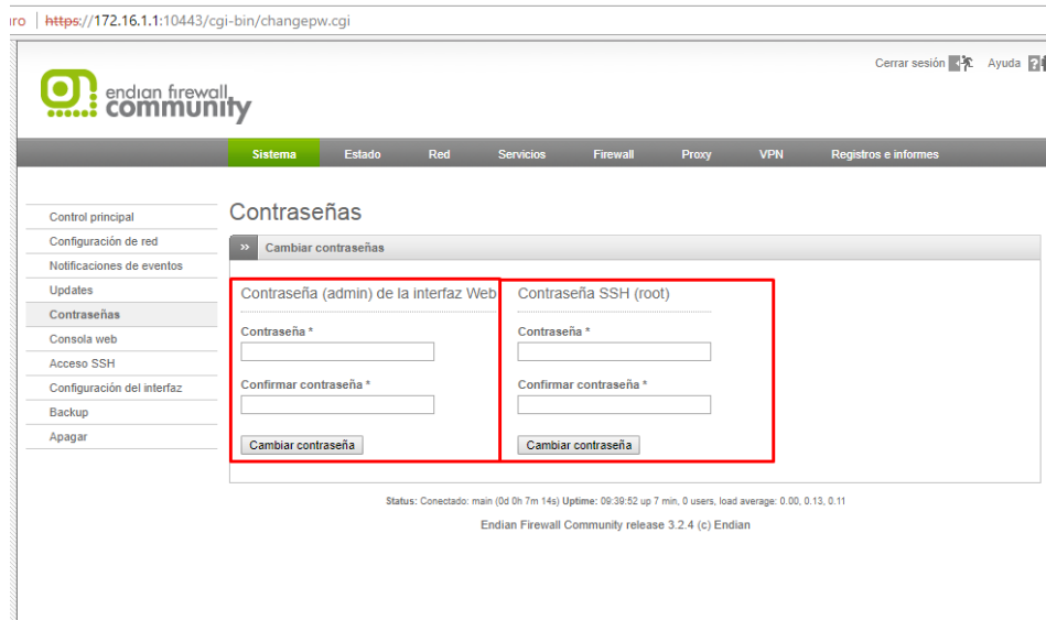
Figura 19. Cambio de contraseña Endian Firewall Fuente: Realizado por el autor
