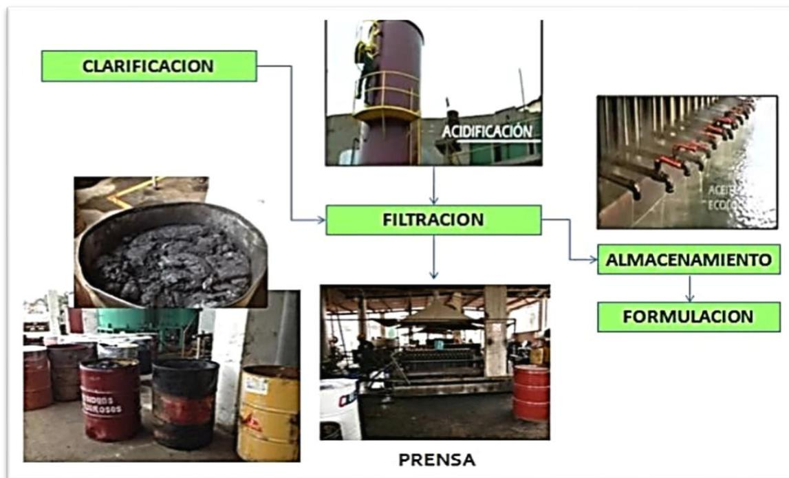
Figura 2. 4. Método de re-refinado del aceite usado
