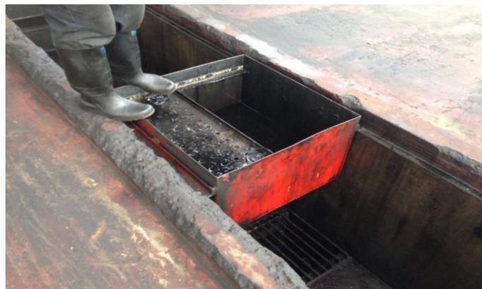
Figura 3. 7. Área de extracción del aceite y filtro
