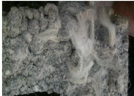
FOTOGRAFÍA 18: Corte transversal de un bloque con 0.4% de acrílico corte lanero.
