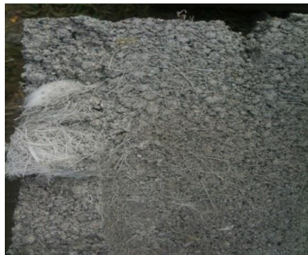
FOTOGRAFÍA 10: Corte transversal bloque con 0,8% fibra de poliéster corte algodónero.
