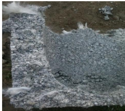
FOTOGRAFÍA 16: Corte transversal de un bloque con 0.2% de acrílico corte algodónero
