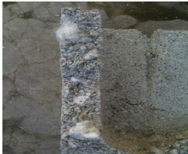
FOTOGRAFÍA 13: Corte transversal de un bloque con 0,2% de polipropileno corte algodónero.
