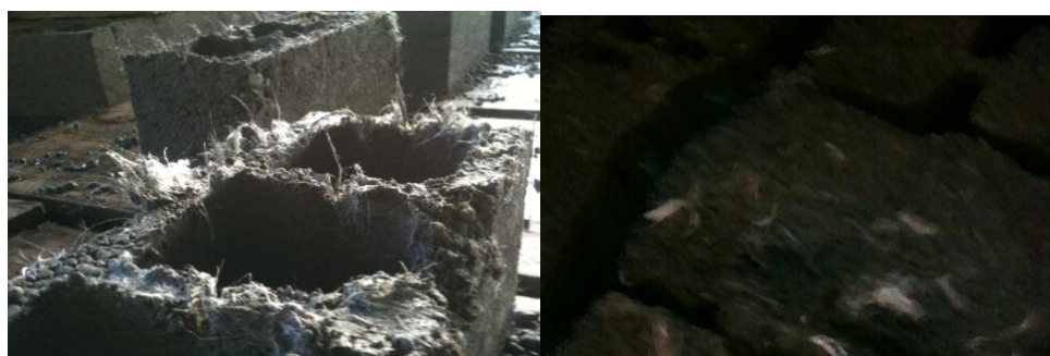
FOTOGRAFÍA 4: Problemas generados durante la fabricación de bloques con PET.
