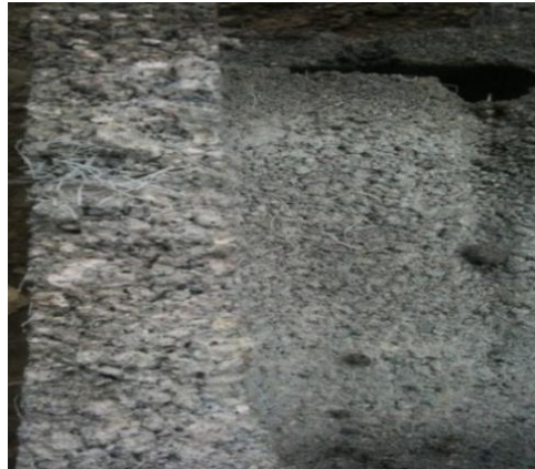
FOTOGRAFÍA 11: Corte transversal de un bloque con 0,2% de poliéster corte lanero.
