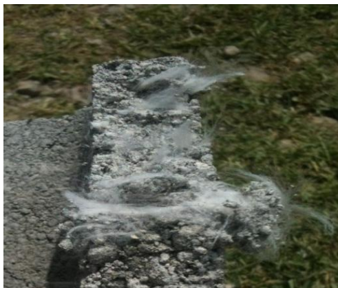
FOTOGRAFÍA 17: Corte transversal de un bloque con 0.4% de acrílico corte algodónero.
