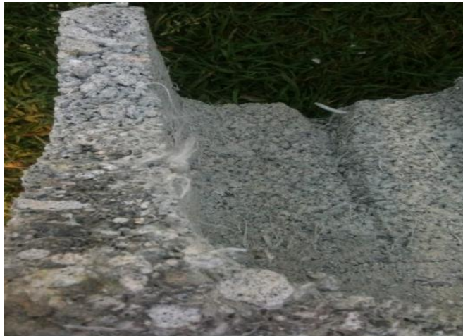
FOTOGRAFÍA 20: Corte transversal de un bloque con 0.2% PET corte algodónero.
