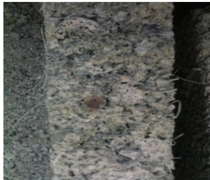
FOTOGRAFÍA 9: Corte transversal bloque con 0,2 % fibra de poliéster corte algodónero.
