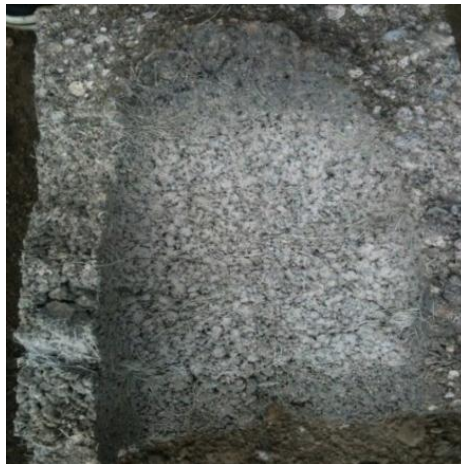
FOTOGRAFÍA 12: Corte transversal de un bloque con 0,6% de poliéster corte lanero.
