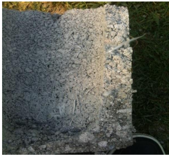
FOTOGRAFÍA 22: Corte transversal de un bloque con 0.2% de PET corte lanero.
