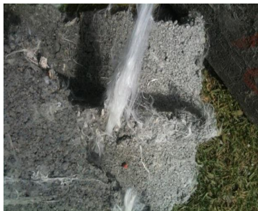
FOTOGRAFÍA 23: Corte transversal de un bloque con 0.8% de PET corte lanero.
