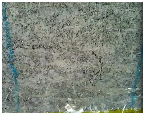
FOTOGRAFÍA 19: Fractura de los bloques con PET durante la flexión
