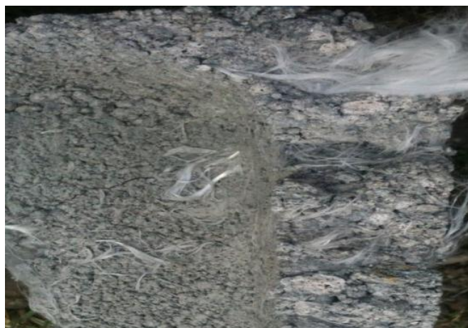
FOTOGRAFÍA 21: Corte transversal de un bloque con 0.6 % PET corte algodónero.
