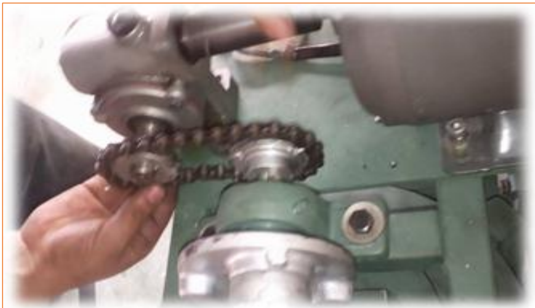
FIGURA 3.58: Montaje de la Cadena
