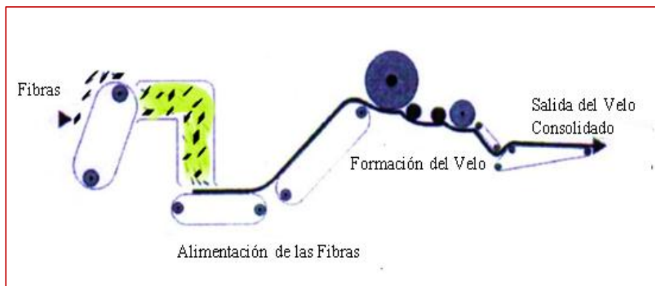
FIGURA 1.19: Proceso de Fabricación por Flujo de Aire (Airlaid)
