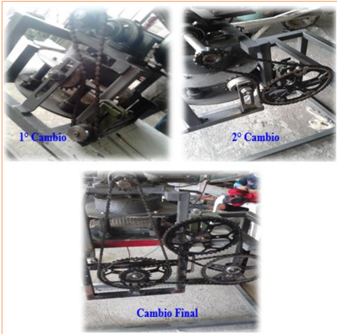
FIGURA 3.59: Cambio y Montaje del Sistema Final de Transmisión de Movimiento
