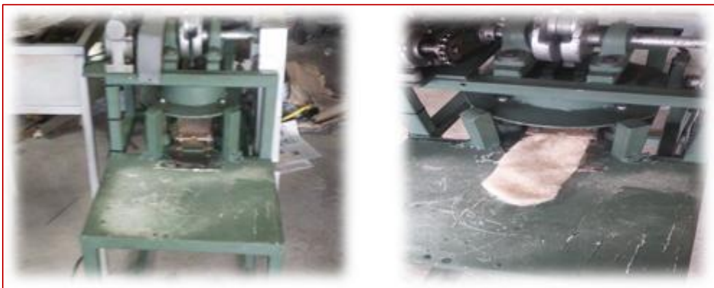
FIGURA 3.55: Montaje del Sistema de Entrada
