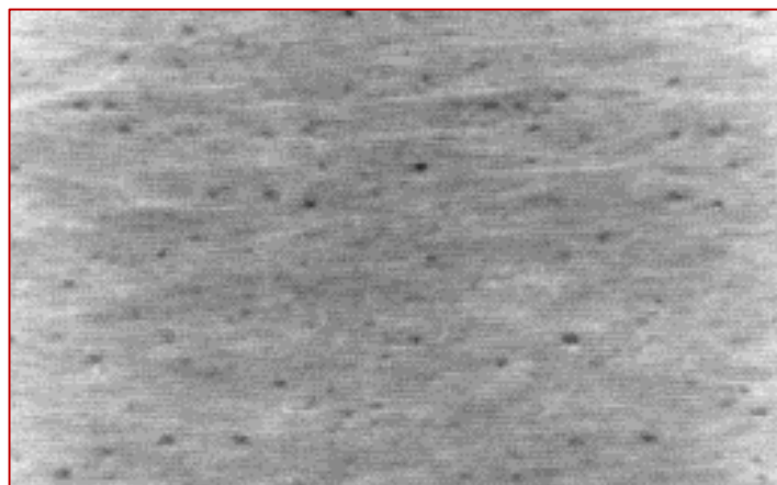
FIGURA 1.29: Foto Ampliada de un No Tejido Resinado
