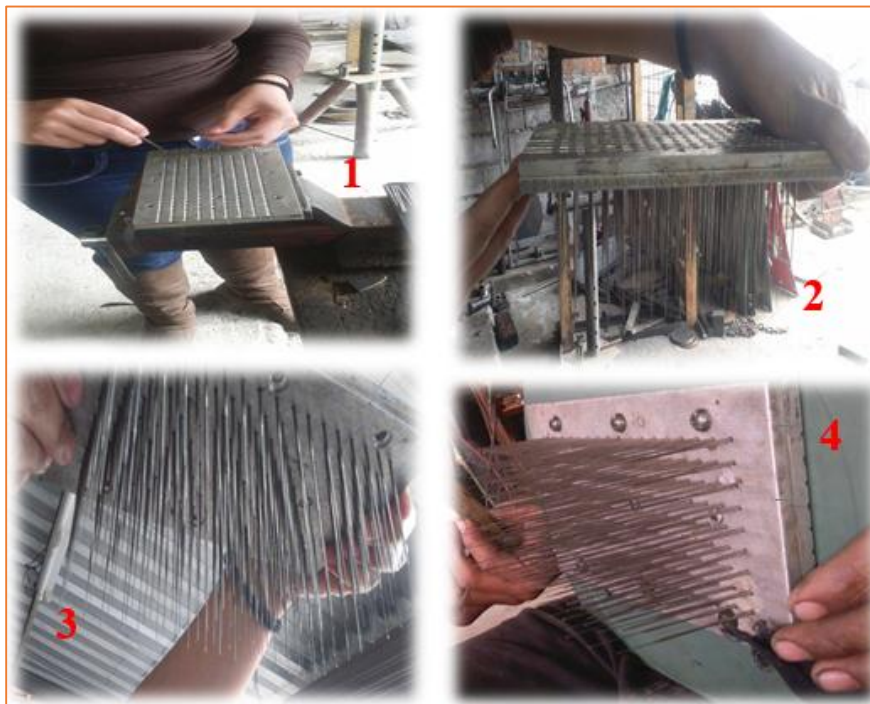
FIGURA 3.49: Montaje de las Agujas de Fieltro
