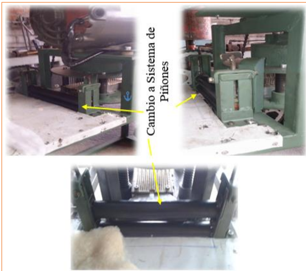
FIGURA 3.57: Transmisión de Movimiento con Sistema de Piñones (Cilindros de Salida)
