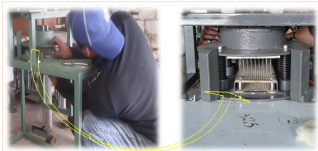
FIGURA 3.52: Montaje de la Placa de Agujas a la Estructura Principal
