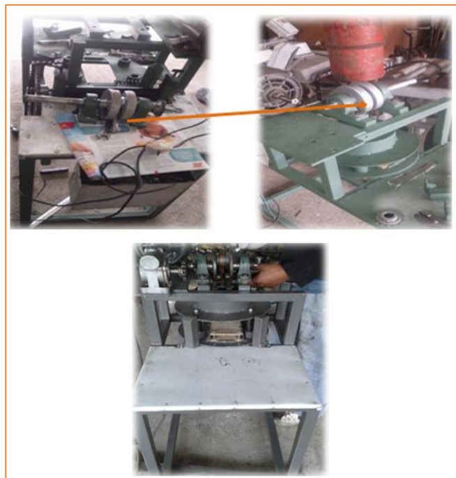
FIGURA 3.54: Montaje de Chumaceras y Sistema de Biela
