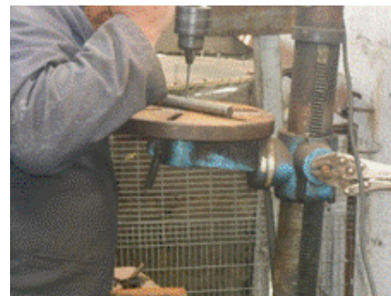
FIGURA 80: realizando terminando el eje ( taladrando )
