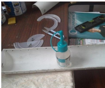
Imagen 36 Tubo de PVC cortado a la mitad
