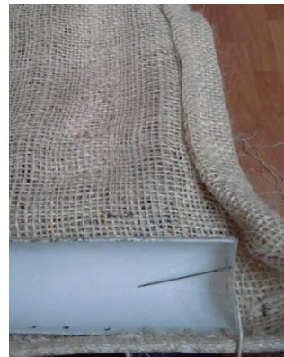
Imagen 61 Ubicación de la canaleta en la malla
