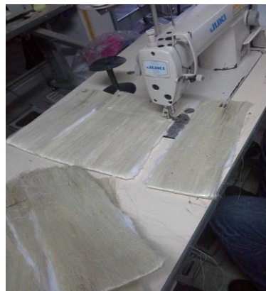
Imagen 16 Muestra respuntada en máquina recta; Imagen 17 Varias muestras siendo respuntadas
