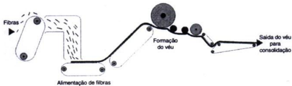
Figura 24 Processo de fabricação via aérea / fluxo de aire (Air Laid)
