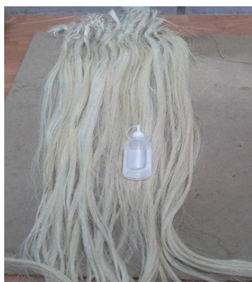
Imagen 11 Cortina de cabuya y adhesivo de silicona; Imagen 12 Materiales empleados
