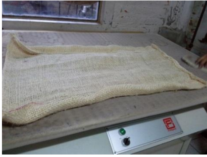
Imagen 54 Malla tejida antes de Vaporizar
