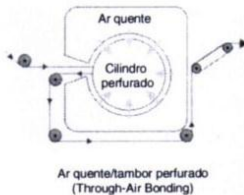
Figura 35 Proceso de consolidación por el pasaje de aire caliente en un cilindro perforado (Through-Air bonding)
