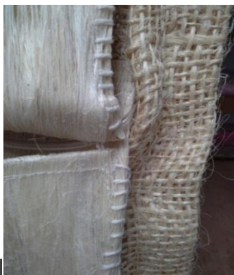
Imagen 70 Costura de puntos soporte del tubo; Imagen 71 Costura del marco superior de la malla
