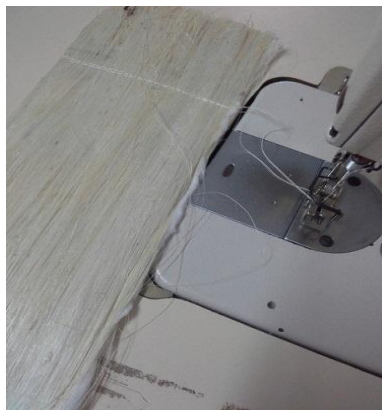
Imagen 16 Muestra respuntada en máquina recta; Imagen 17 Varias muestras siendo respuntadas
