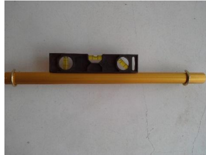
Imagen 95 Nivelación de los soportes de cortina
