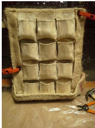
Imagen 127 Inmovilización del sustrato en el panel
