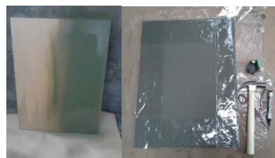
Fig. 13. Impermeabilización del panel de madera
