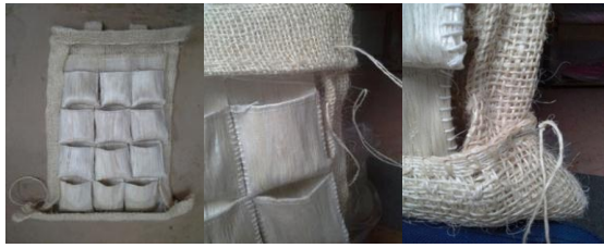
Fig. 8. Costura de Bolsillos, Canaleta y Tubo de Pecera.
