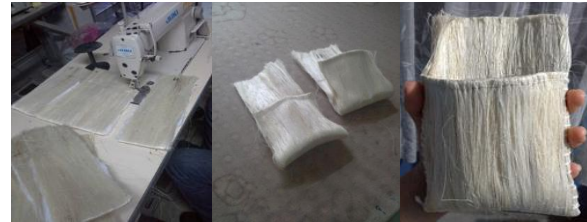
Fig. 4. Moldeado y costura de bolsillos
