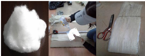
Fig. 3. Elaboración de las muestras no tejidas
