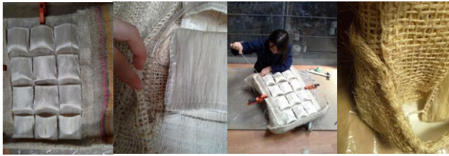
Fig. 14. Costura de canaleta, marcos laterales, manguera y base
