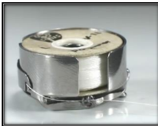
IMAGEN 7.9: Enhebrado De La Bobina Paso 2 Elaborado por: Rubí Cusin
