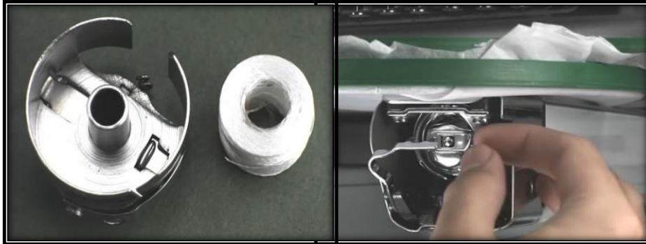
IMAGEN 7.8: Enhebrado De La Bobina Paso 1 Elaborado por: Rubí Cusin
