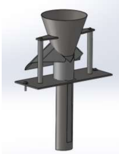
Figura 3.15 Sistema de formado del material de empaque
