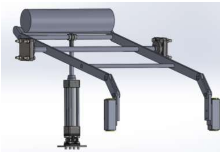
Figura 3.31 Sistema de arrastre del material de empaque
