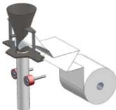
Figura 2.12 Sistema de arrastre por rodillos.
