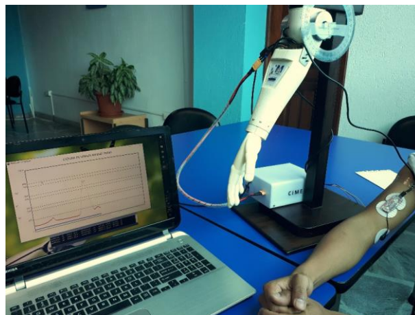
Figura 3.64 Movimiento prono-supinación, contracción fuerte (-50°).
