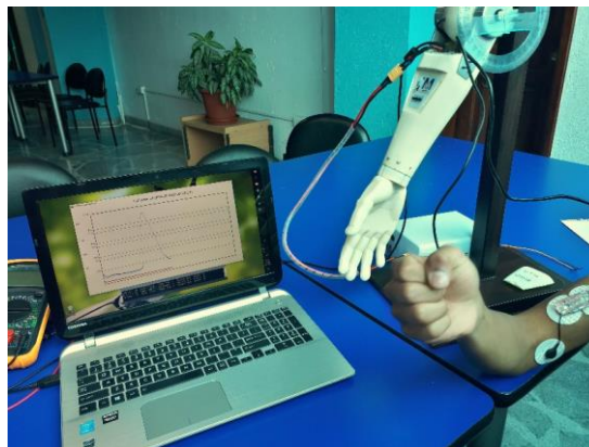
Figura 3.66 Movimiento flexión-extensión, contracción fuerte (30°).
