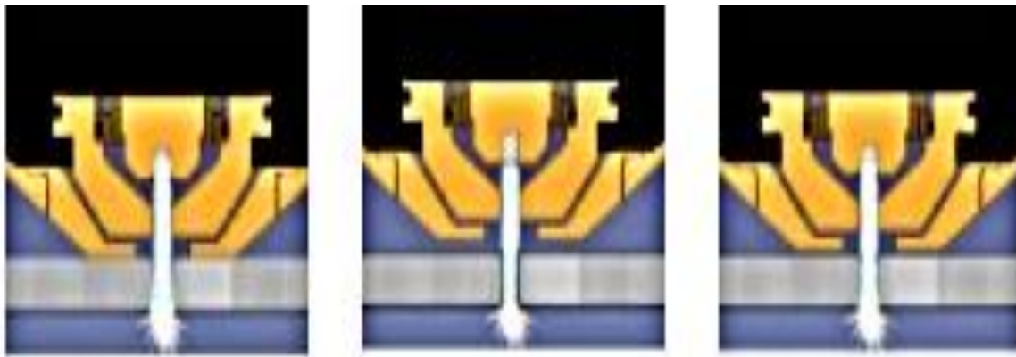
Figura 2.9 Controlador de altura de la antorcha (Teodoro, 2016, pág. 84)
