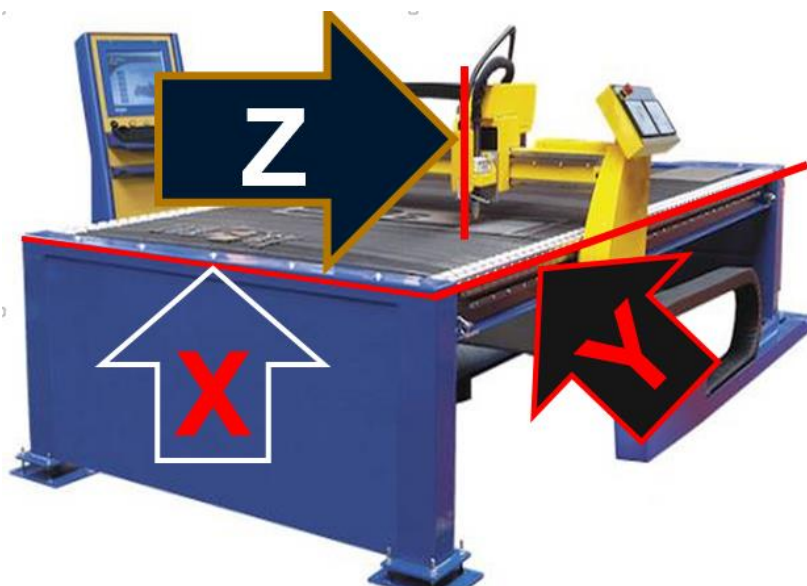
Figura 2.25 Identificación de referencia (Fabricator, 2017, pág. 2)
