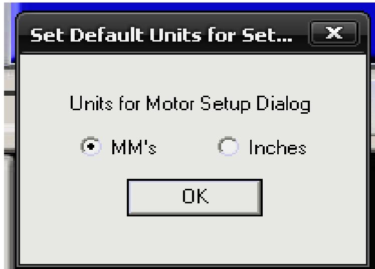
Figura 3.15 Selección de medidas (Mach3 loader)
