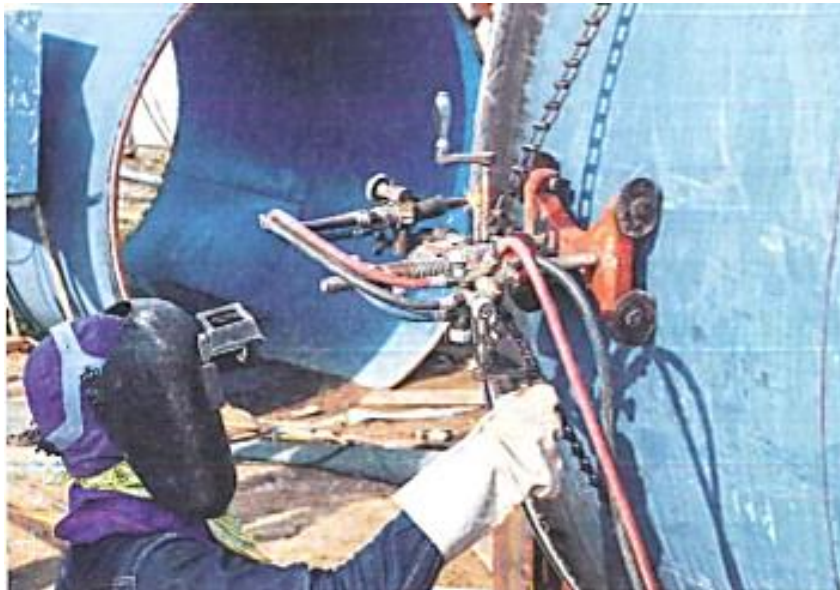
Figura 2.10 Mecanismo tipo carro portátil (Teodoro, 2016, pág. 52)
