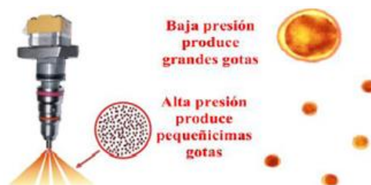
Figura 2.8 Mejor atomización del combustible (Morales y Sangucholeines, 2013, p. 8)
