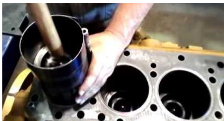
Figura 3.12. Montaje del pistón en el bloque motor
