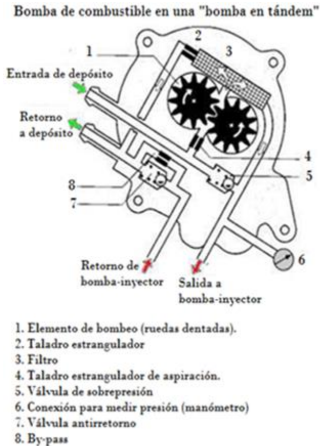
Figura 2.36 Bomba de Transferencia de Combustible (Caterpillar, 2012, p. 60)
