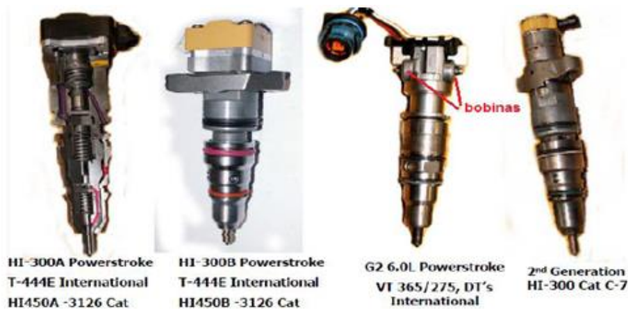
Figura 2.9 Tipos de inyectores (Morales y Sangucholeines, 2013, p.11)
