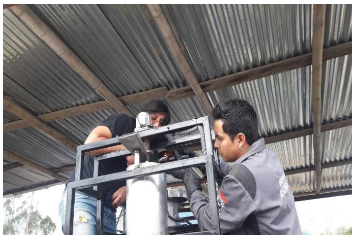
Figura 2.12. Colocación del hidróxido de sodio, adición del alcohol metílico
