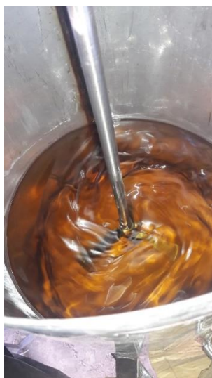
Figura 2.13. Mezclado del aceite con la solución catalítica
