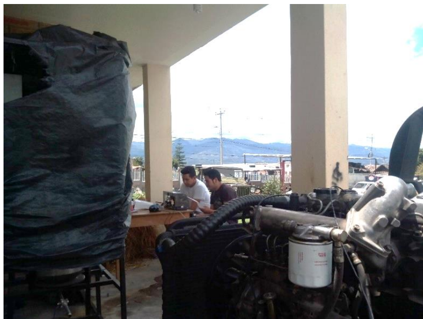
Figura 3.19. Pruebas de opacidad en motor Mitsubishi 4D31T
