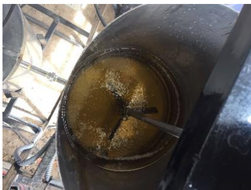
Figura 2.14. Mezclado final previo la obtención de mezcla B100
