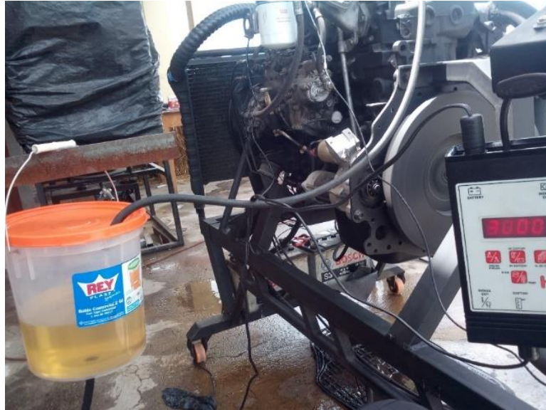
Figura 3.17. Pruebas de gases contaminantes con mezcla B5
