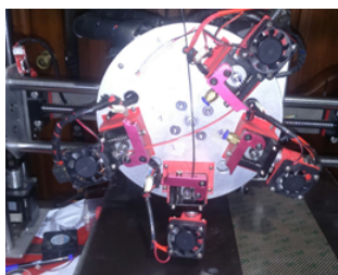
Figura 13. Sistema multiextrusor montado sobre el eje X.
