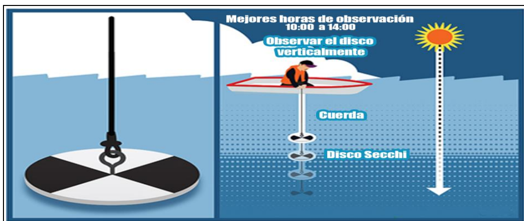
Figura 3.5. Disco secchi, forma y hora de hacer las mediciones.
