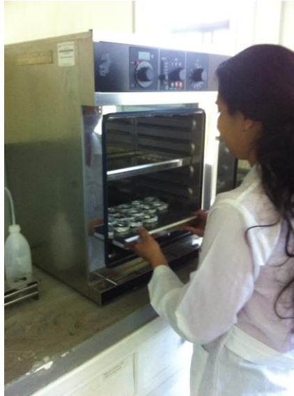
Figura 12. Ingreso de muestras de suelo a la estufa en el laboratorio de la Universidad Técnica del Norte
