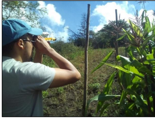
Figura 6. Medición de pendiente con el clinómetro
