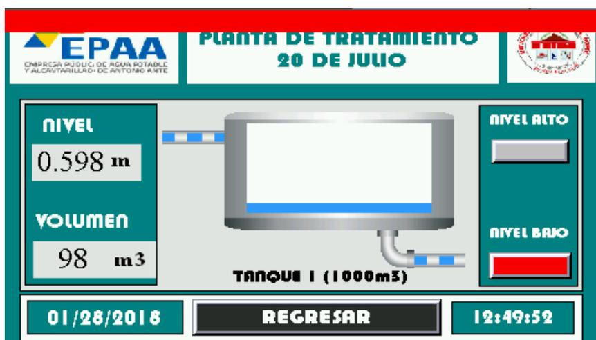
*Figura 23. Pantalla de nivel y volumen de agua.*
