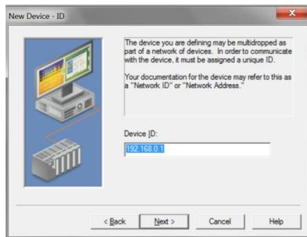
**Figura 2. 30** Configuración dirección IP
