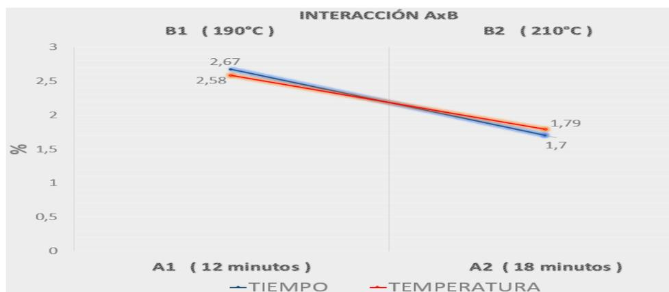
**Figura 25.** Interacción Tiempo – Temperatura. Humedad del grano tostado
