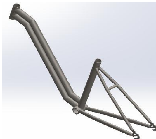
Figura 4.34. Marco de acero de 73^\circ , para construir vista isométrica.
