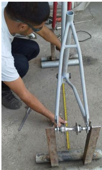
Figura 5.11. Medición longitudinal de los soportes laterales.
