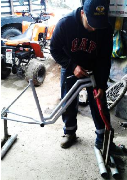
Figura 5.10. Montaje de los soportes y el marco de bicicleta.
