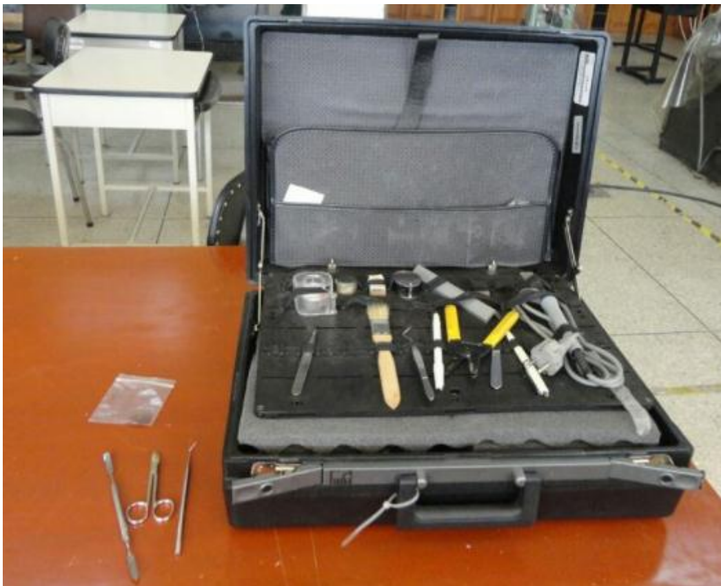
Figura 5.14. Equipo necesario para la instalación de las galgas extensiométricas.
