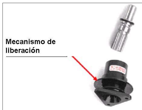
Figura 2.6. Mecanismo de liberación del volante rápido SPA Design. (Cantos, 2011, pág. 20)
