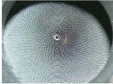
Figura 2.5. Panal del Catalizador Oxidante
