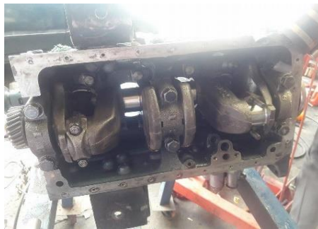
Figura 3.5. Estado del cigüeñal
