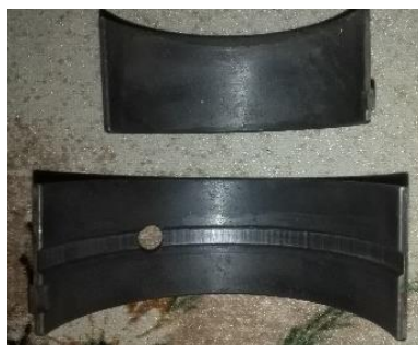
Figura 3.4. Estado de chaquetas de biela y bancada
