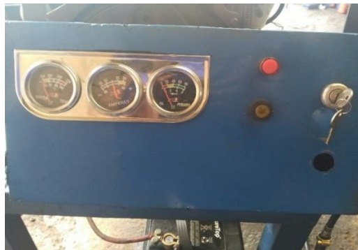
Figura 3.13. Tablero de instrumentos
