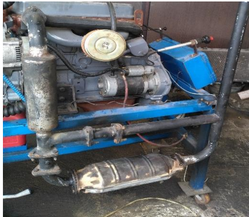
Figura 3.14. Sistema de escape
