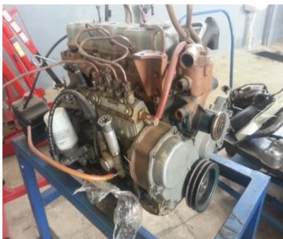
Figura 3.1. Motor Nissan SD22
