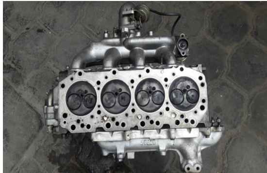
Figura AVI.1 Desmontaje del cabezote
