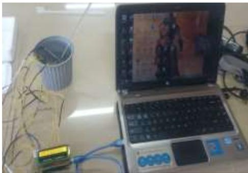
**Descripción:** Para la toma de lectura de las variables necesarias para el cálculo de la eficiencia del panel solar, se utilizan aparatos especializados en cada variable ya sea de viento o temperatura. Los sensores una vez calibrados y mediante el controlador se logran visualizar en la pantalla LCD los diferentes valores de temperatura medidos en el panel solar plano.
