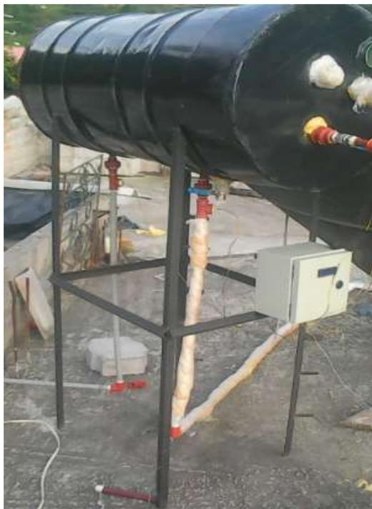
**Descripción:** La construcción del soporte para el panel solar y acumulador se lo realizó a base de perfiles de acero, mismos que suministrarán soporte al tanque acumulador, a la caja de control y al colector solar. En el soporte consta de patas soldadas en los ejes verticales, lo cual permite la realización de las pruebas del colector solar a diferentes ángulos de inclinación.
