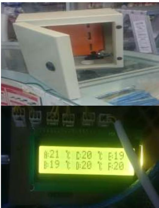
**Descripción:** Es un gabinete con certificación ISO 9001:2008 y IEC 60529 se montaran el sistema de control, que constara de un dispositivo arduino el cual será el encargado de tomar las diferentes temperaturas medidas por los sensores y mostrar su valor en una pantalla LCD.
